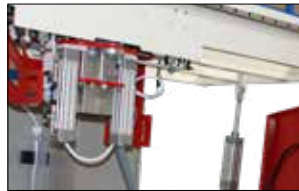
UNIDAD DE FRESADO INFERIOR PARA CREMONA LOWER MILLING UNIT FOR CREMONE
