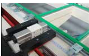
SISTEMA DE TOPES PARA COTA FIJA STOP SYSTEM FOR FIXED NUMBER
