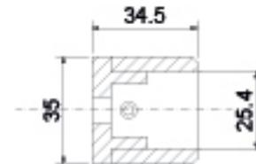
Conector redondo con fijación a muro. Para tubo de 1".
