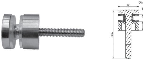
Conector con chapetón y base recta para vidrio templado de 6 a 19 mm. Carga máxima 20 kg. Incluye taquete expansivo.
