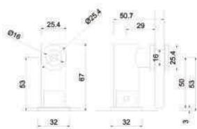
Conector muro-vidrio 90° con chapetón. Para vidrio de 8 a 12 mm.
